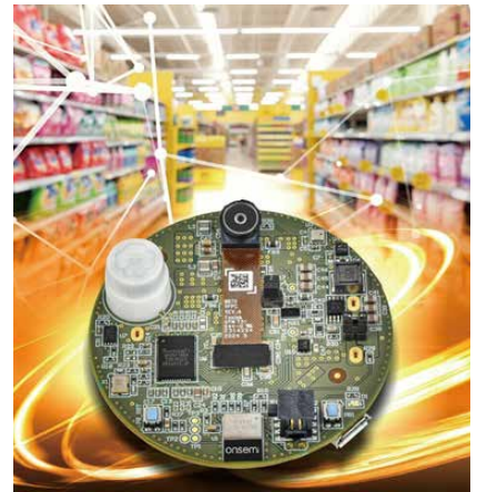
图1：通过AI支持事件触发成像的低功耗相机平台。
